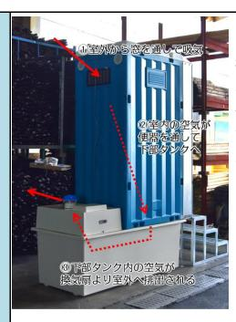
トイレ室内の便器から室外換気扇を使って排気する 臭い逆流防止機能。 タンク内でバイオ処理され ているため、トイレ周辺の 臭いも軽減されています。
